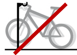
Lenkerhalter: Wird wenig benutzt und beschädigt Brems-, Licht- und Schaltkabel.
