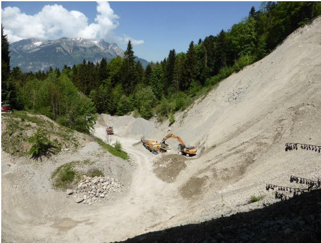
Abbildung 2: Blick von oben in die Kiesabbaustelle Oberwald (8.5.2018). Der Bagger beschickt den temporär eingemieteten Brecher. Der Pneulader verschiebt das gebrochene Material auf die Depots.
