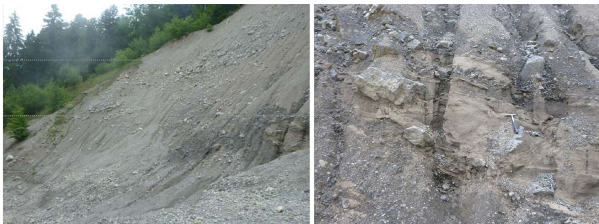
Abbildung 2: Stauschotter im Oberwald Kerns (980 mü.M.): Links ist die deutliche Schrägschichtung erkennbar, rechts ein Detailbild der synsedimentären Strukturen. Deutlich erkennbar sind auch die Feinanteile, welche eine gute Verdichtung der Schotter erlauben.
