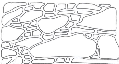
Typisches Fugenbild einer Natursteinmauer mit wenig bearbeiteten Bruchsteinen unterschiedlicher Abmessungen. Das Höchstmass der Steine war durch das vom Maurer zu bewerkstelligende Gewicht beschränkt. Keile und kleinformatige Steine füllen die unregelmässigen Lager- und Stossfugen auf.
