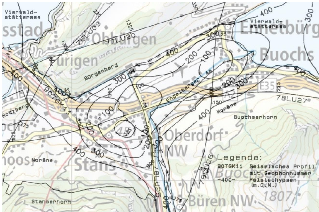
Abb. 59 Basis Lockergestein bzw. Rinne in m ü.M.
