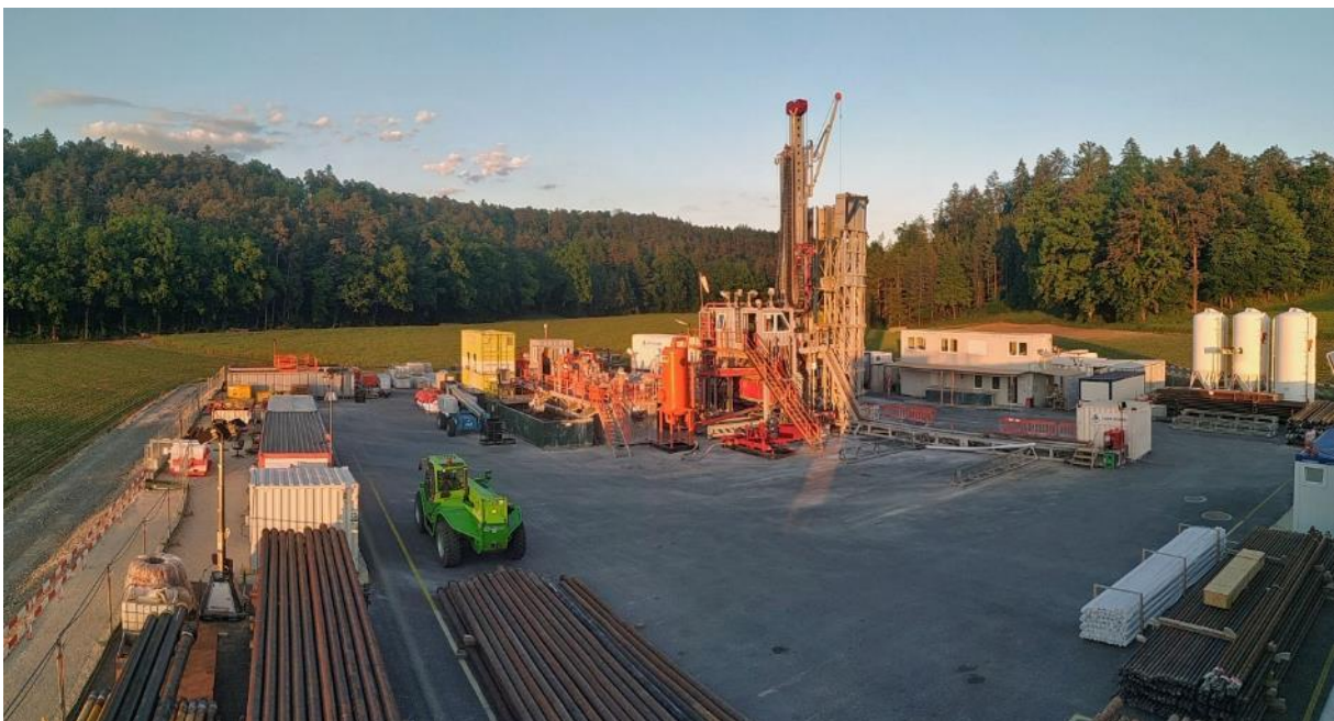
Abb. 58 Bsp. für eine Bohranlage für mittlere Tiefen
