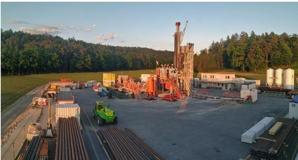
**Abb. 58 Bsp. für eine Bohranlage für mittlere Tiefen**
