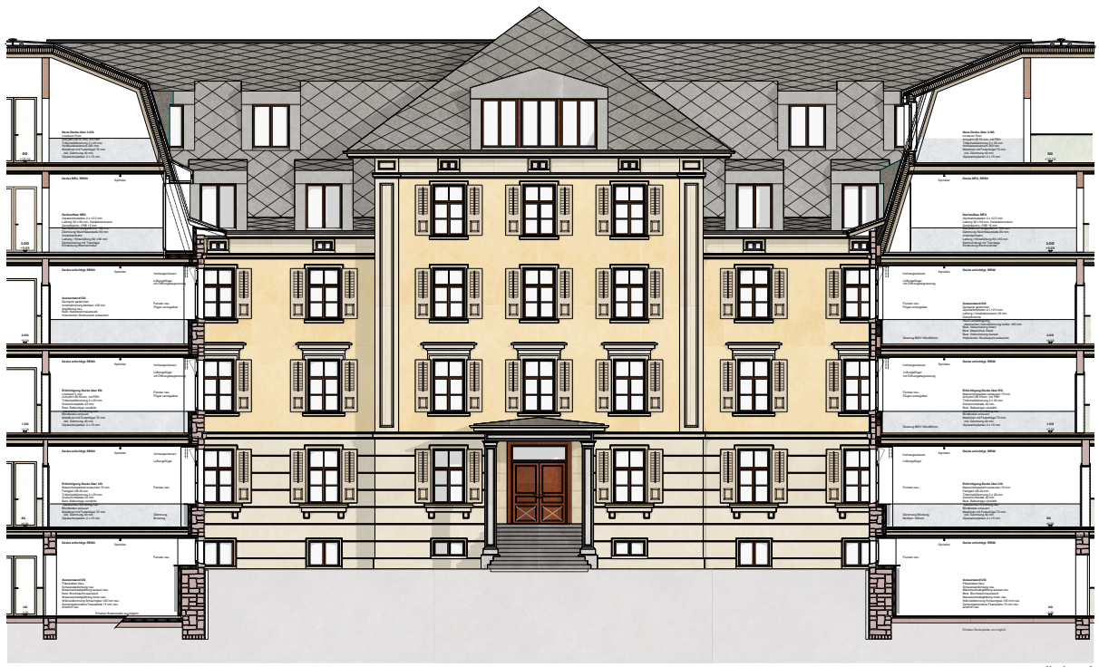
Konstruktionschnitt, südlicher Teil Mauerwerk 1:50
