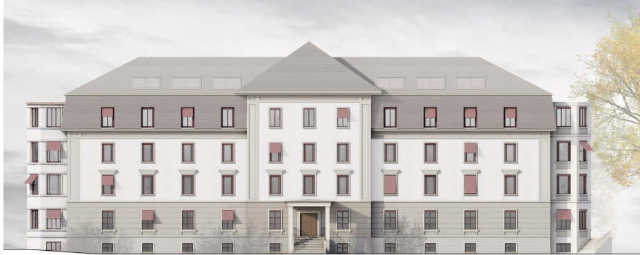
Symmetrie, Technik, Gliederungselemente und Proportionen prägen das Erscheinungsbild des historischen Baus. Dekorative Teile (Giebelstirn) und schwach warme Farben können (je nach Befund) die Färbung der Fassade bestimmen.
