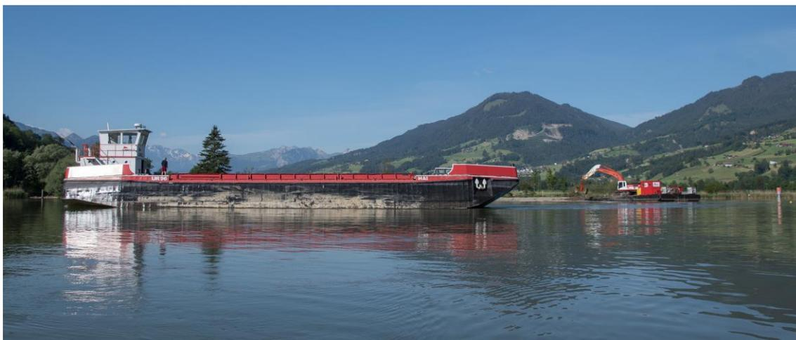
Abbildung 7: Klappschiff vor Entladen des Schüttmaterials in der Mündungsbucht (Foto: Urs Winterberger, Juni 2020).
