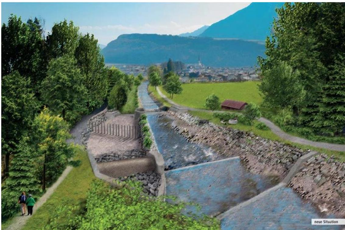
Abbildung 4: Visualisierung des Entlastungsbauwerks im Gebiet Chlewigen bei normalem Abfluss der Kleinen Schliere
