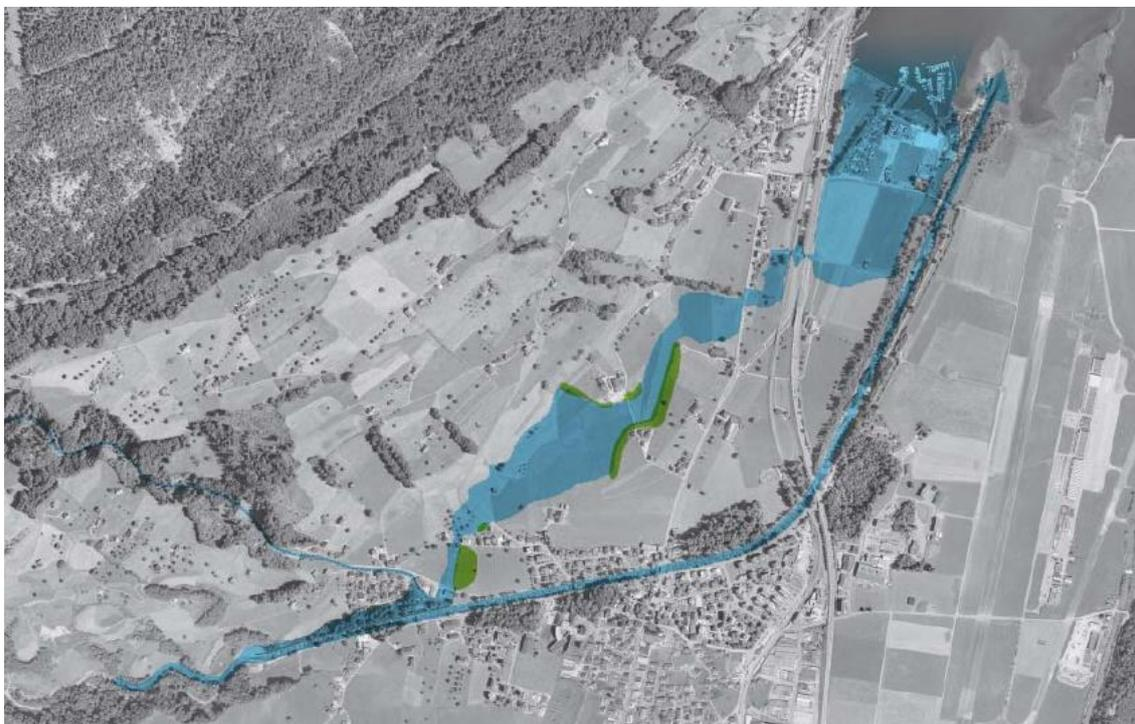
Abbildung 5: Der Entlastungskorridor (blau) führt über die landwirtschaftlich genutzten Flächen dem See zu. Die grün eingezeichneten Gelände- und technischen Massnahmen sind zur kontrollierten Ableitung der anfallenden Wassermassen notwendig, damit keine Wohnhäuser betroffen sind.
