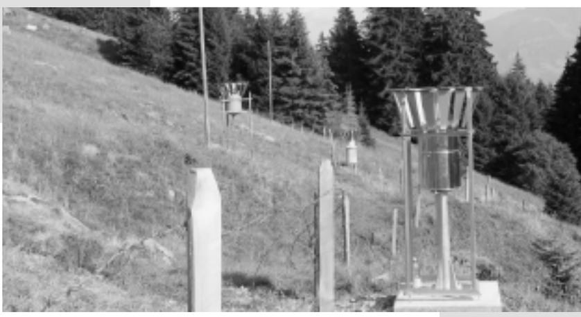
Lütoldsmatt: neue automatische Niederschlagsmessstation (rechts), zwischenzeitlich abgebaute alte Niederschlagswaage (Mitte) und Totalisator (links) zur Erfassung der Niederschlagsmengen und Intensitäten im Einzugsgebiet der Kleinen Schliere.
