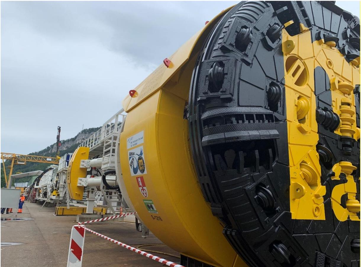
Bild 2: Der Bohrdurchmesser beträgt 6.53 Meter. Im hinteren Teil der Tunnelbohrmaschine, dem sogenannten Nachläufer, wird im Vortrieb die Innenauskleidung aus Spritzbeton aufgebracht. Danach steht noch ein Durchmesser von 5.90 Meter für die maximale Abflusskapazität des Hochwasserentlastungstollens von 100°000 Litern pro Sekunde zur Verfügung (Bild: Bau- und Raumentwicklungsdepartement Obwalden).
