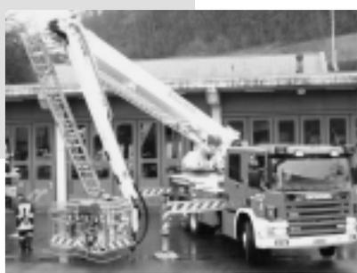
Das neue Hubrettungsfahrzeug der Feuerwehr Sarnen mit einer Arbeitshöhe von 32 Metern kann multifunktional und insbesondere zur Personenrettung eingesetzt werden.
